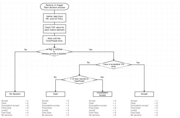
Figure 18: Mass triggerの判定フロー。
