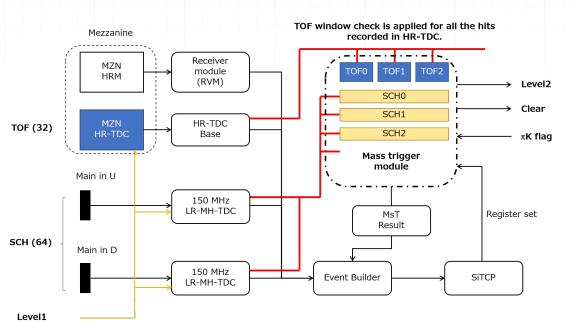
Figure 16: Mass triggerのブロック図。
