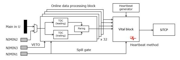
Figure 19: Streaming TDCのブロック図。
