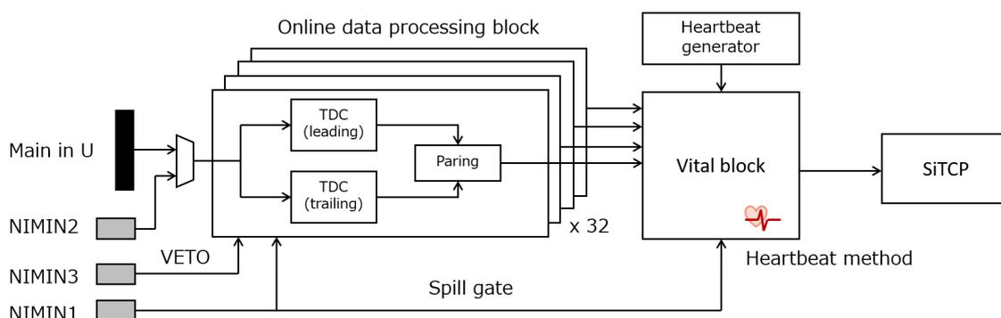
Figure 19: Streaming TDCのブロック図。
