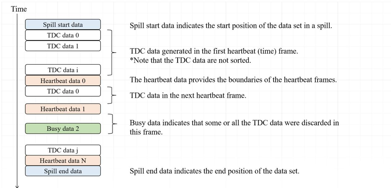
Figure 20: Streaming TDCから出力されるデータの並び順
