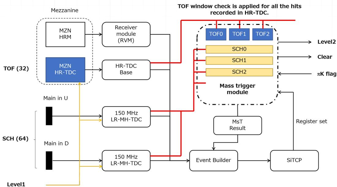
Figure 16: Mass triggerのブロック図。
