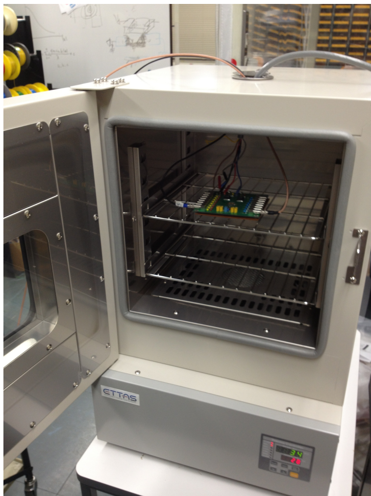
図 3.20: KEK の恒温槽を用いて ASIC の温度依存性を調べた。
