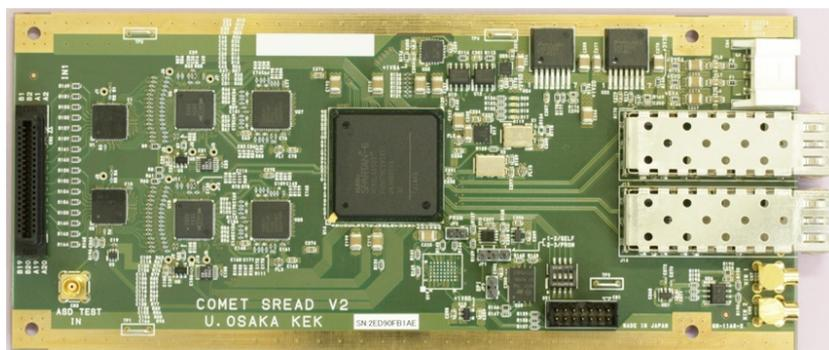
図 2.2 ROESTI のプロトタイプの写真。大きさは 8 cm × 18.5 cm であり要求は満たしている。
