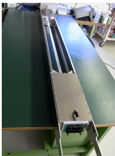
図 1.11 評価に使われたストローチェンバーの試作機
