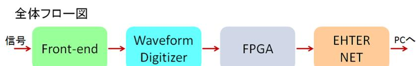
図 2.1 ROESTI の全体フロー図。ストローチェンバーからの信号は左から入力されて、デジタル化され PC へ送られる。
