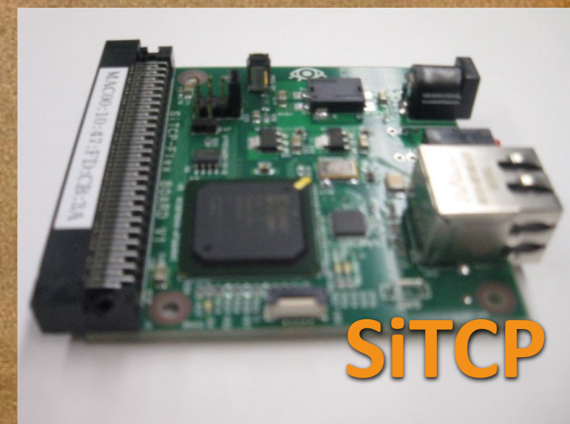
TCP/IPプロトコルの必要な部分をハード化
