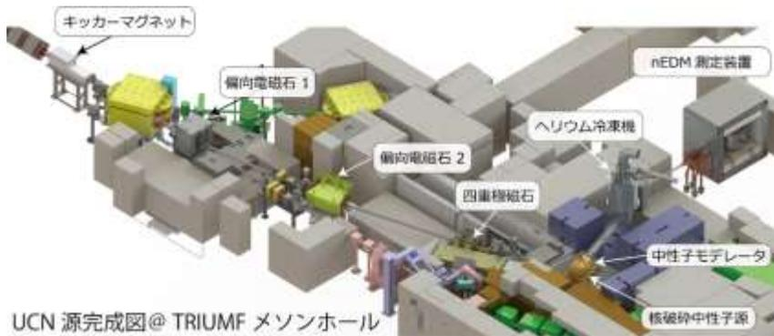
日本・カナダの国際共同実験であるTUCAN (TRIUMF Ultra-Cold Advanced Neutron)実験に参加しています。その目標は中性子EDMを $10^{-27}$  ecmの精度で測定することです。そのために**世界最高強度のUCN源**をカナダ・TRIUMF研究所に建設しています。UCNは核破砕反応で生じた高速中性子をスーパーサーマル法によって冷却することにより生成されます。日本でプロトタイプUCN源が製造・試験され、2017年に現地でのUCN生成に成功しています。
