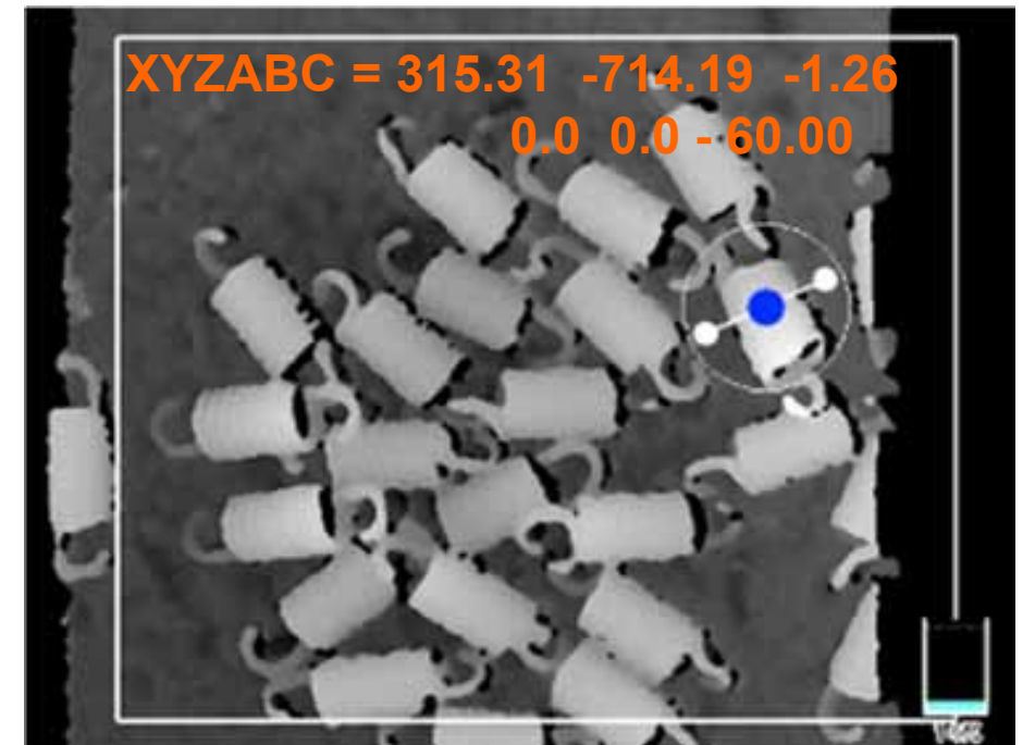
ばら積み部品の把持点認識処理例
