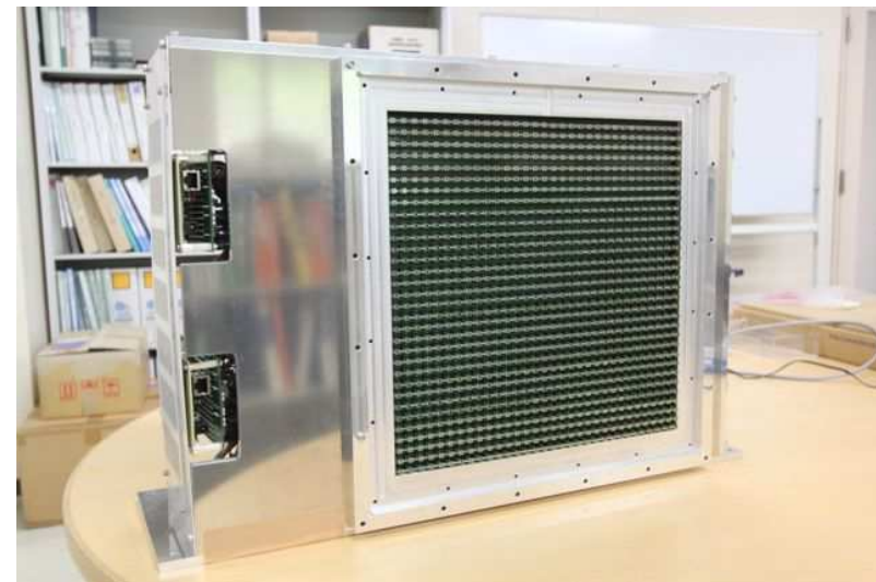
調整中の1号機 アルミ窓シンチレータは取り外してある
