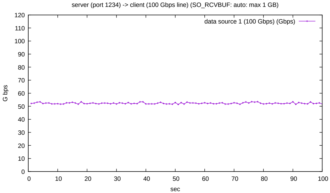
(a) 読み出しプロセスが動作する CPU コアとキュー処理 CPU コアを固定し、それぞれの CPU コアが L3 キャッシュを共有するようにセットしたときのスループット。平均 52.3 Gbps。
