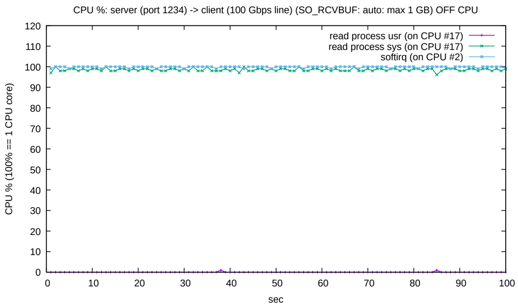
(b) 読み出しプロセスの sys% と usrCPU 消費量。1 コア全部使っている場合を 100% としてプロットしている。
