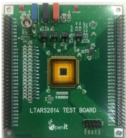
図 8.2.1 開発したテストボード V2
