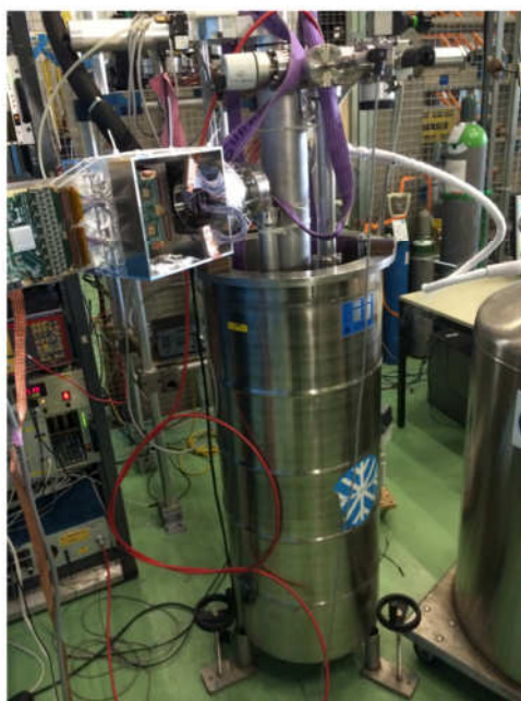
図 3.4.1 3L 小型気液二相アルゴン TPC 測定器
