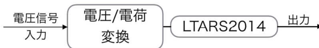
図 3.3.5 テストボードの全体構成
