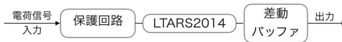
図 3.3.19 アナログボード回路概略図
