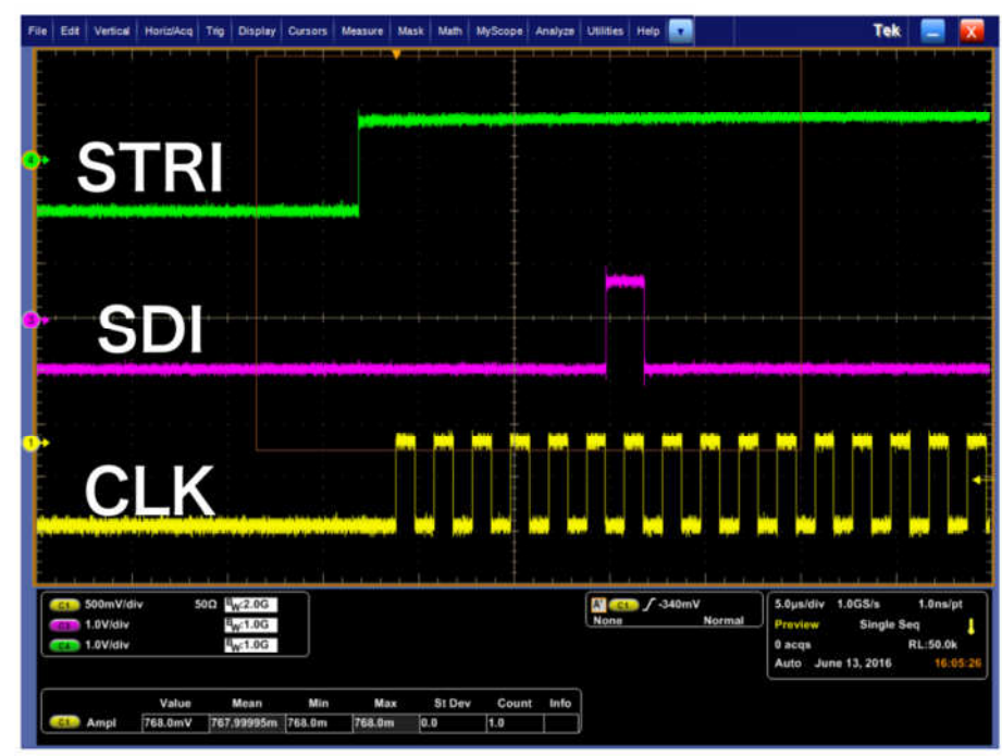
図 4.3.24 DAC コントロール動作試験 デジタルボード出力
