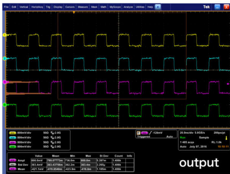
図 4.4.9 NIM 信号分配器の出力波形
