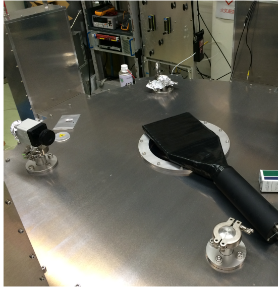
図 2.13: 宇宙線を用いた MIP 測定のセットアップの様子。写真中央付近の黒いものがシンチレータである。
