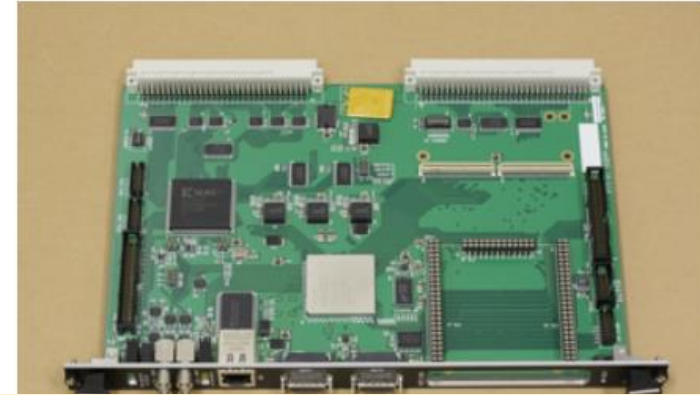
PT7-汎用VMEマザーボード (東大坂本) general purpose test board (PT7)
