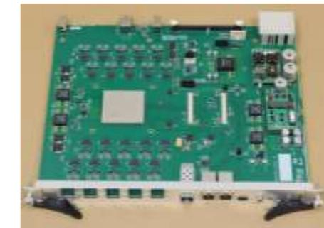
1桁上の細分化、高速化、放射線耐性強化を実現した検出器の開発
