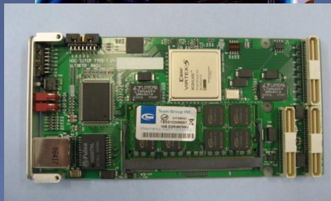
CCD読みだしモジュール（東大 相原研）
