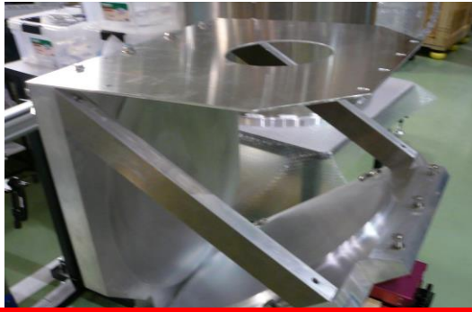
クロス-ドラゴン 反射光学系 @ 4 K 開口径 30 cm、視野 20°
