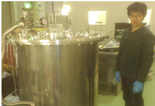
クライオスタット パルス管冷凍機、 ヘリウム吸着式冷凍機搭載
