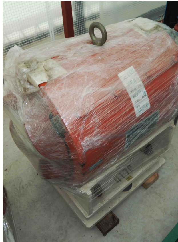
50A/12V 空冷 長さ 50cm 重さ～800kg(架台込み)
