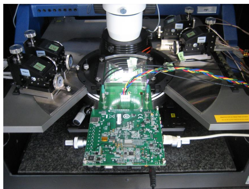
プローブカードを取り付けた状態
