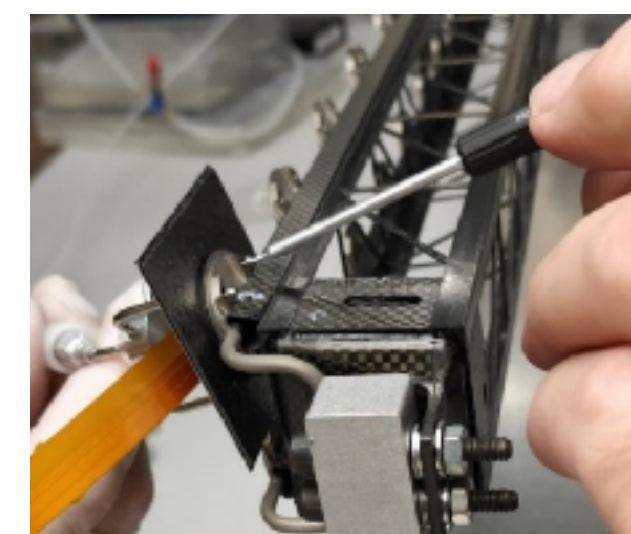
CellのCooling Blockを利用して支柱のパイプへ固定
