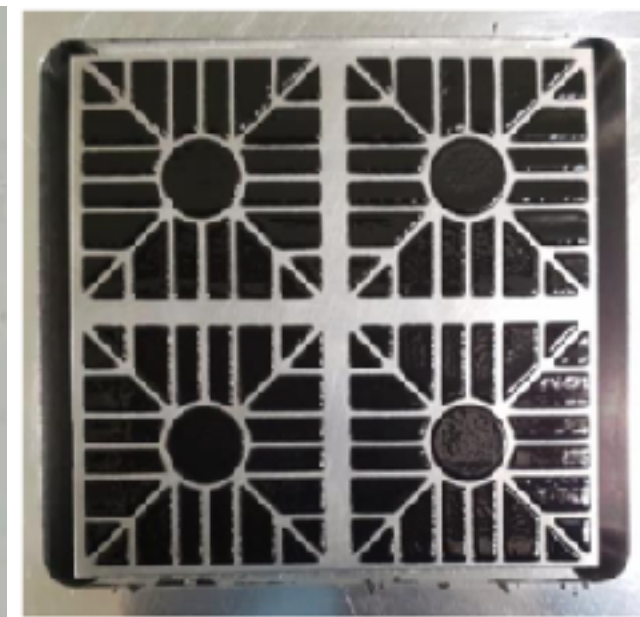
塗布された Cellの接着剤
