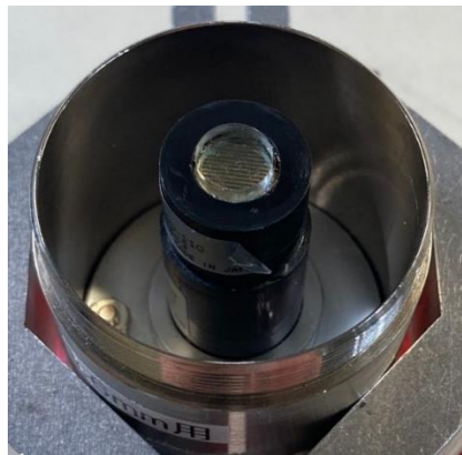
PMTにシンチレータ設置
