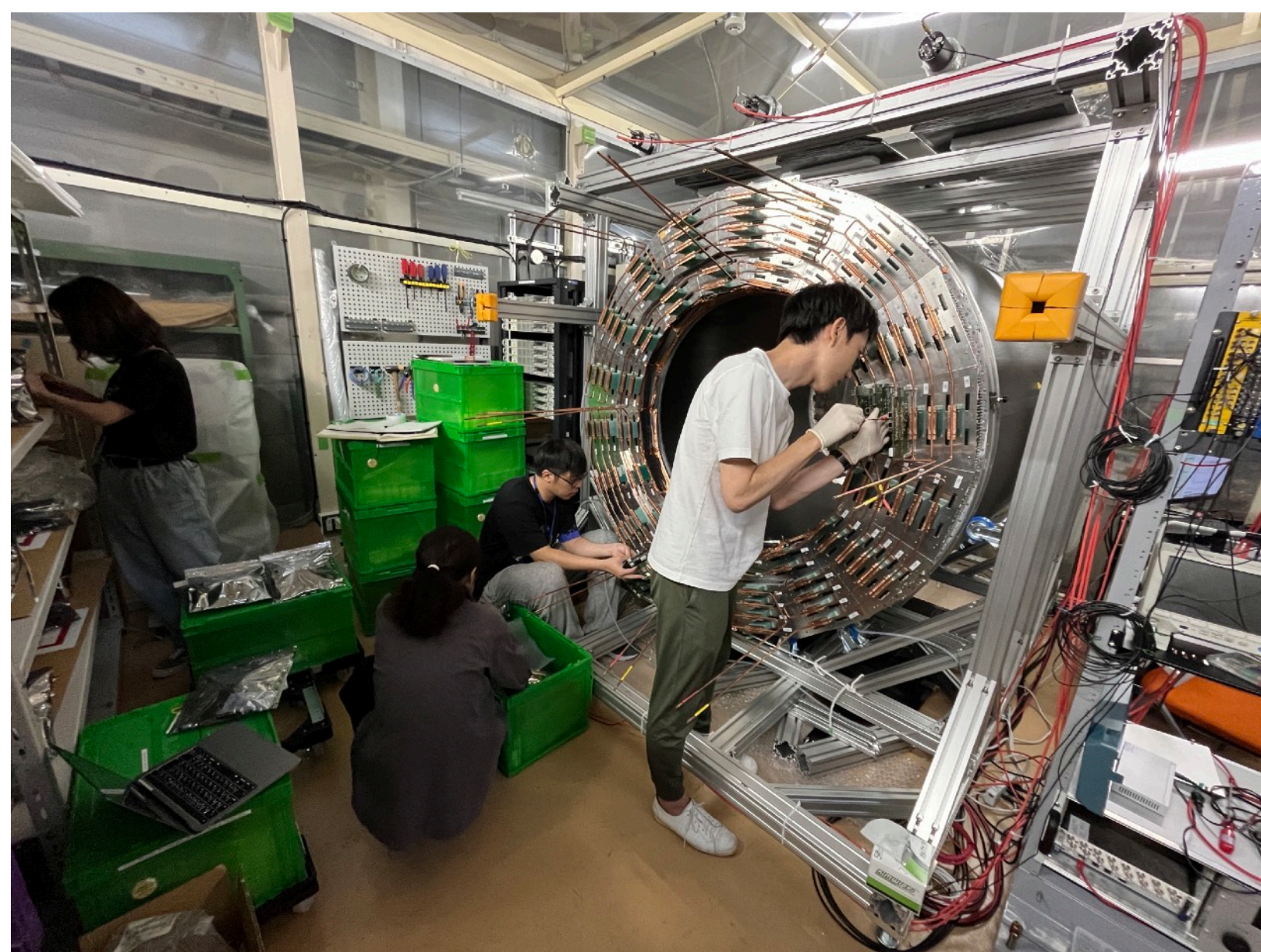
RECBE設置作業中
