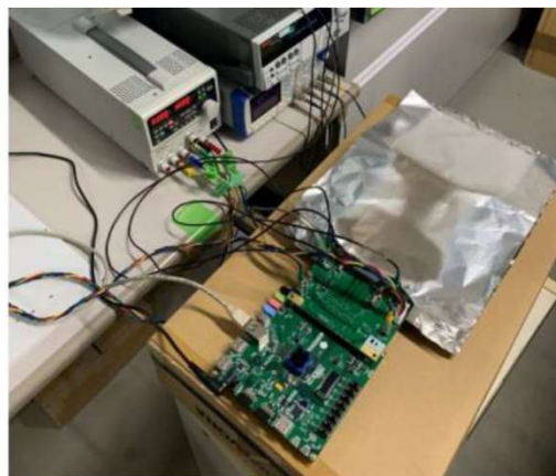
試作機にアルミ箔を被せた
