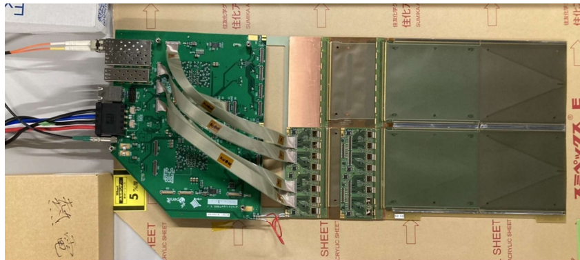
Grounding検討(シールド×、冷却板導通○)
