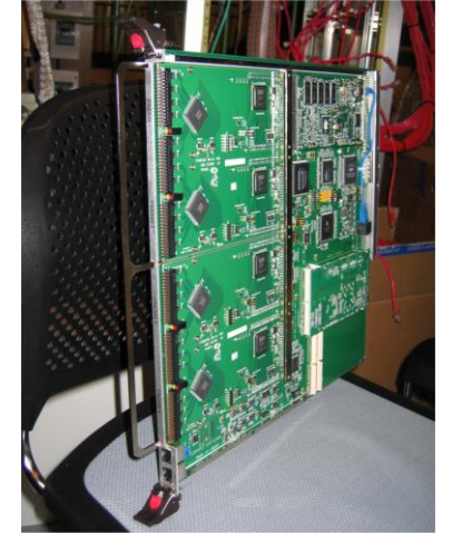
On board PC base Readout platform module Network をハンドリングするために PC を搭載した。
