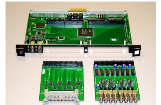
KEK-VME general I/O (NIM/ECL/LVDS)
