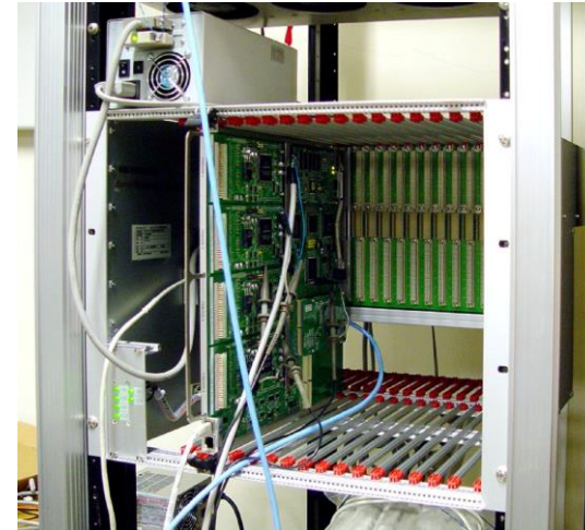
On board PC base Readout platform module Network をハンドリングするために PC を搭載した。
